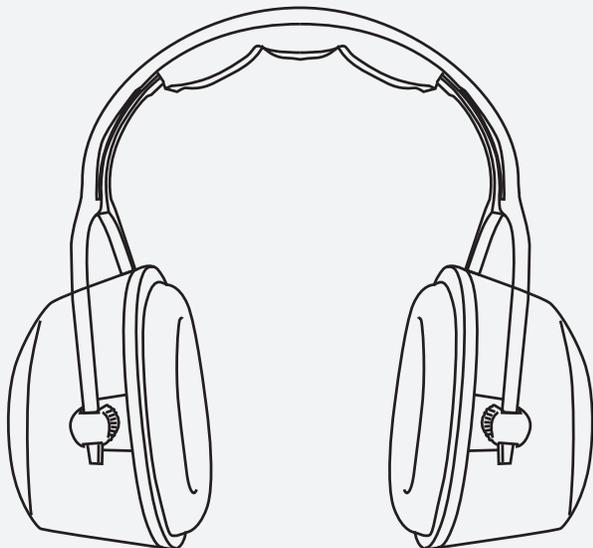
Suministra protección de manera no invasiva, aislando el oído de la fuente de ruido. Se denominan normalmente protectores de copa. Diseño ergonómico y adaptable a la mayoría de los usuarios. Máxima atenuación y excelente prestación en ambientes con ruido de baja frecuencia. Compuesto básicamente por 2 orejeras vinculadas por una vincha:
