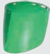
**Verde:** brinda protección a los reflejos y radiación IR (filtra del orden del 80% de la radiación IR). Apto para tareas en altos hornos. No apto para tareas de soldadura.
